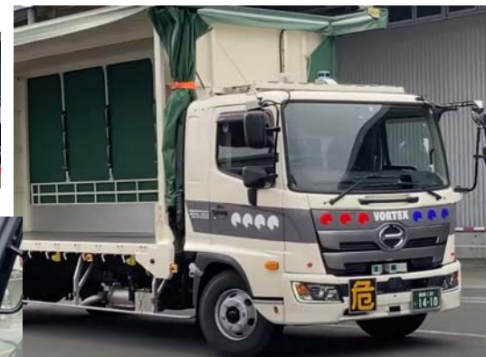
（上図）自動運転レベル4相当の場内無人搬送実証実験中の無人トラック （左図）フォーク作業者にタブレットで動作を指定されて無人トラックが動く様子
