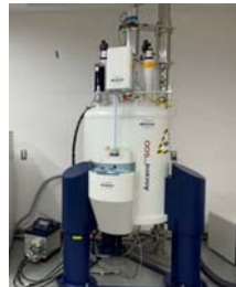
(左図) 分析装置の一例 核磁気共鳴装置(NMR)
